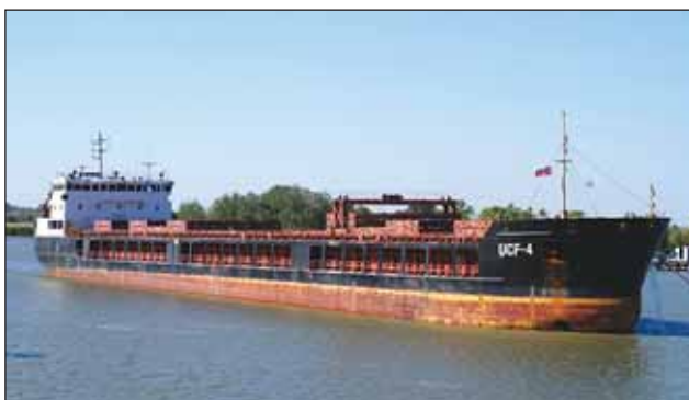
Рис. 7. Люковые закрытия и козловой кран судна пр. RSD18
