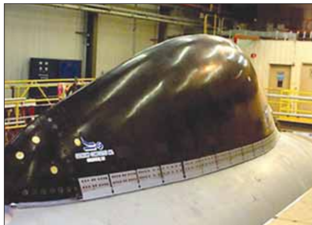
Новое ОВУ из композитного материала
