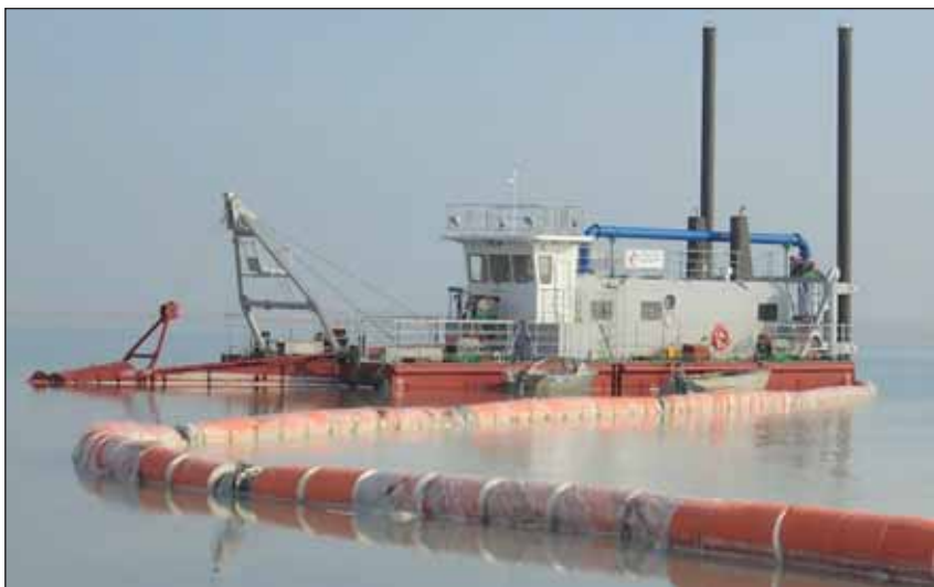
Дизель-электрический земснаряд 800-40 (АО «Цимлянский СМЗ»)
