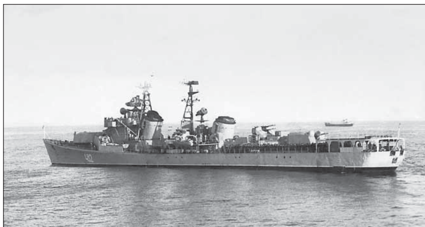
Эсминец «Светлый», оборудованный кормовой взлетно-посадочной площадкой, с которой отработывались полеты легкого вертолета Ка-15
