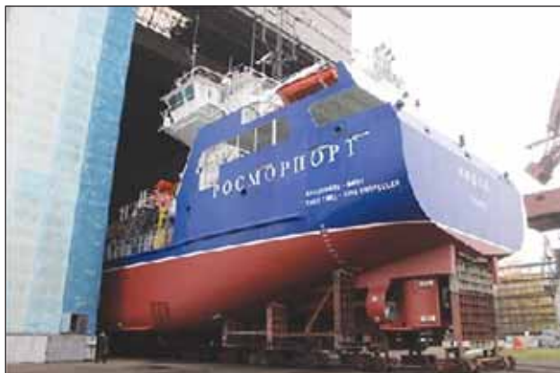
Вывод из цеха ПАО «Завод «Красное Сормово» дноуглубительного судна «Кадош» для последующего спуска на воду
