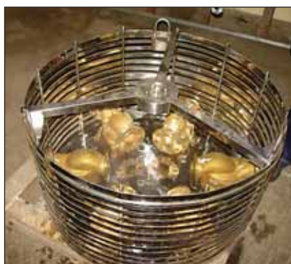
Рис. 5. Детали в корзине после процесса пропитки
