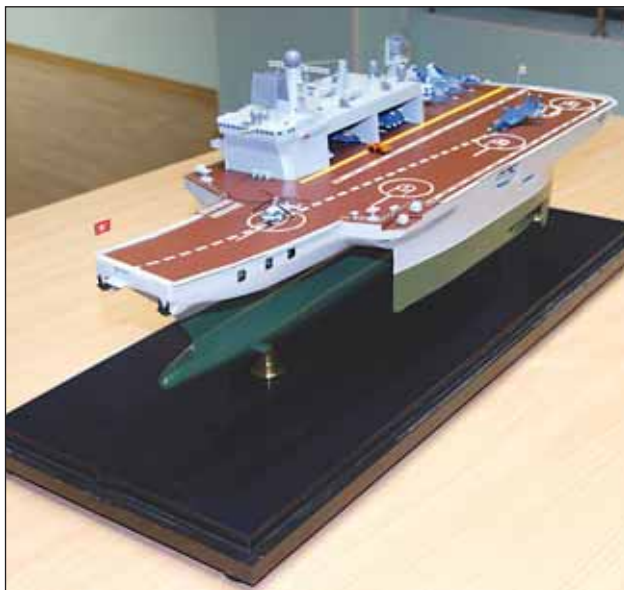
Модель корабля с малой площадью ватерлинии с тремя корпусами
