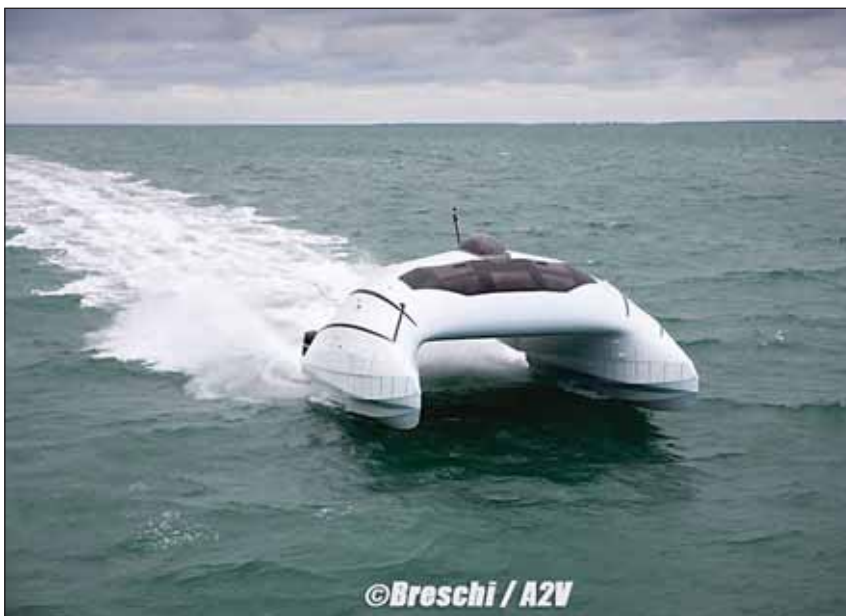
Рис. 1. 10-метровый прототип скоростного судна с аэродинамической разгрузкой. Полное водоизмещение 4,5 т, скорость 40 уз при мощности двигателя 2 x 200 л. с. (фото Christophe Breschi)
