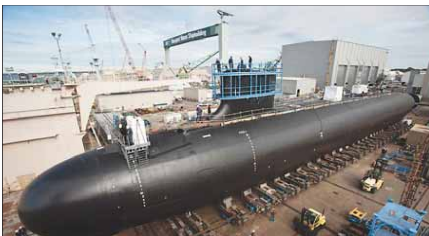
Подготовка к спуску на воду очередной АПЛ типа «Virginia», облицованной гидроакустическим покрытием
