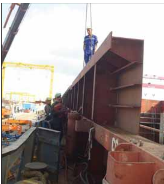
Увеличение высоты комингсов на сухогрузе «Ополье» ( www.meb.com.ua )
