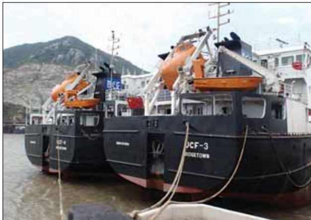
Рис. 13. Спасательная и дежурная шлюпки в кормовой части судов
