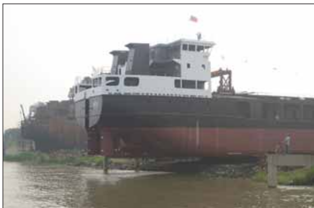
Рис. 14. Спуск на воду судна UCF-2 пр. RSD18 в Китае. Начало движения судна по стапельным «бананам»
