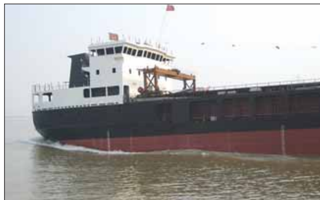
Рис. 15. Спуск на воду судна UCF-2 пр. RSD18 в Китае. Кормовая оконечность уже в водоизмещающем положении, носовая продолжает скользить по «бананам»
