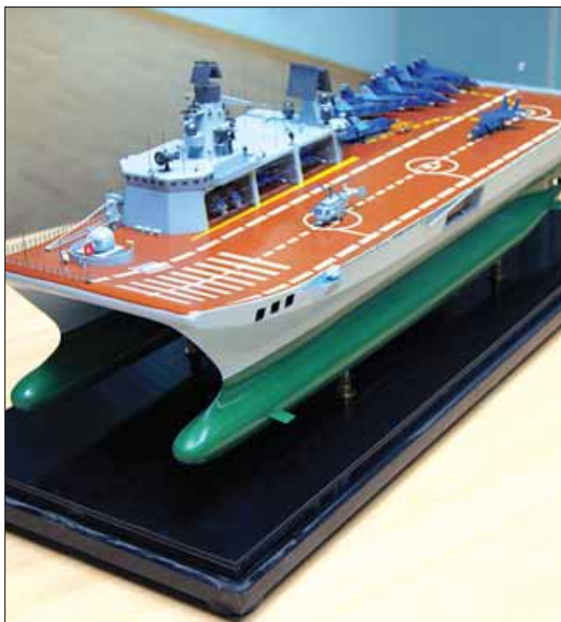
Модель двухкорпусного корабля с малой площадью ватерлинии
